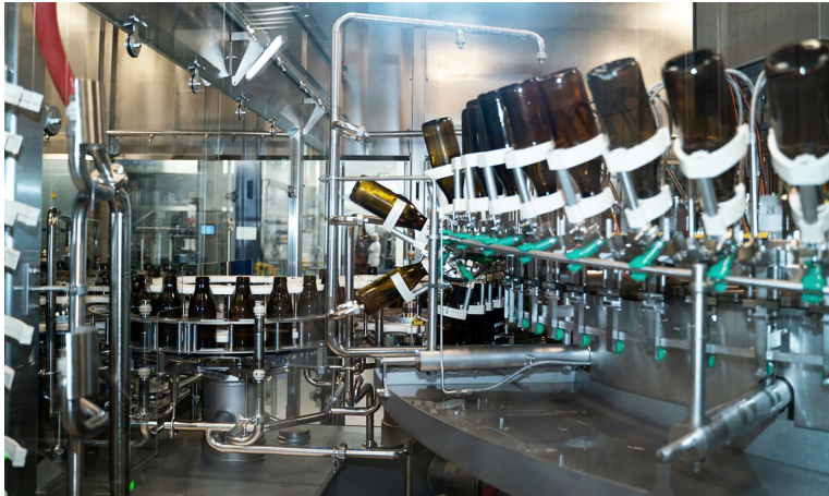
Bild 4: Die neue Krones-Flaschenreinigung sichert absolut saubere Mehrwegflaschen bei deutlich reduziertem Laugen- und Wasserverbrauch.
