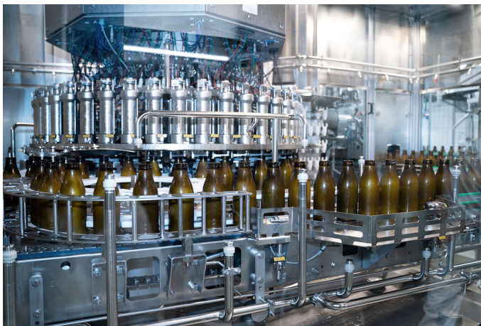
Bild 5: Exakt 1 Liter wird dank des 45-Wiegezellen-Rundfüllers in jede Flasche gefüllt. Dazu wird jede Flasche einzeln gewogen und dann entsprechend der Dichte von Vollmilch mit 1.030 g bzw. fettarmer Milch mit 1.032 g je Flasche befüllt.
